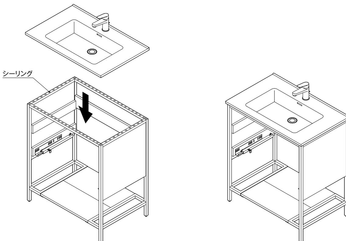
2. キャビネット設置後、カウンターと壁をシリコーン系シーリング材で埋める。
