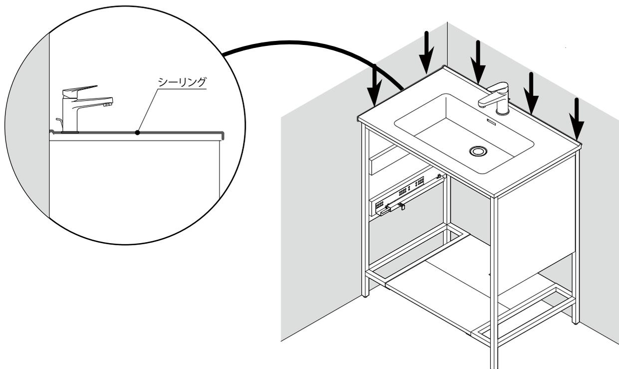
キャビネット設置後、必ずカウンターと壁をシリコーン系シーリング材で埋めてください。
