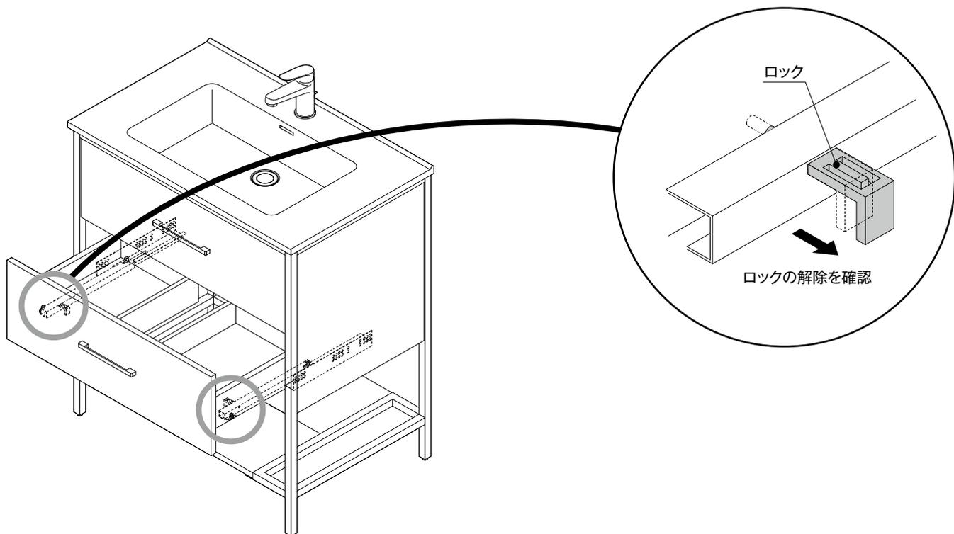
3. レール手前側の突起に引出し底部の穴を差し込む。
