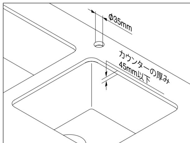
水栓取付穴とカウンターの厚みが適合していることを確認してください。
