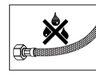
設置後のホースは、いかなる物質も接触し続ける状態にしないでください。ホースの損傷や破裂をまねく恐れがあります。
