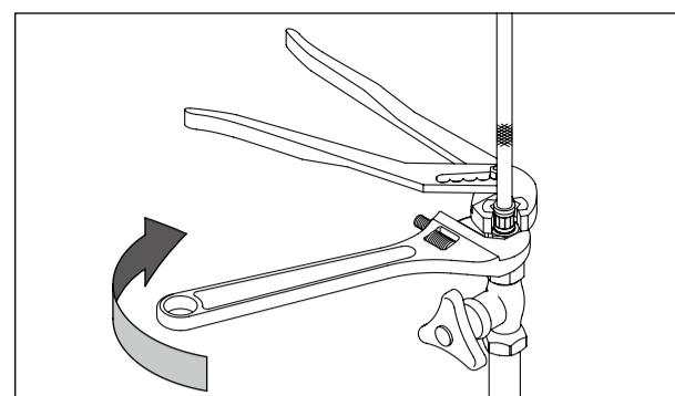
③ フレキシブルホースが動かないようレンチ等で押さえながらナットをスパナー等で増し締めします。締め付けトルクは目安として(シートパッキン)5～7N·mです。
