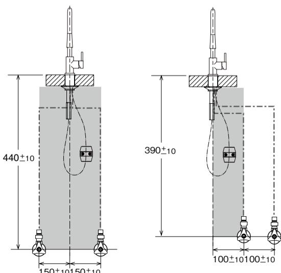
給水管、給湯管がシャワーホース、シャワーホース用重り、及び排水トラップとの干渉を避けるため、各止水栓は下図に従って配置してください。
