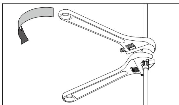
③ 手でしっかりと締めた後、シャワーホースがよじれないようにスパナ等で押さえ、袋ナットを1/2～3/4回転増し締めします。締め足りなかったり、締めすぎると水漏れの原因となります。
