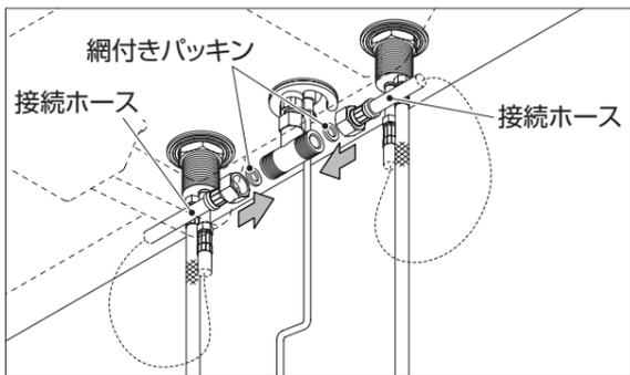
⑨ T型ジョイントに給水側、給湯側レバーハンドルの接続ホースを取り付けます。
