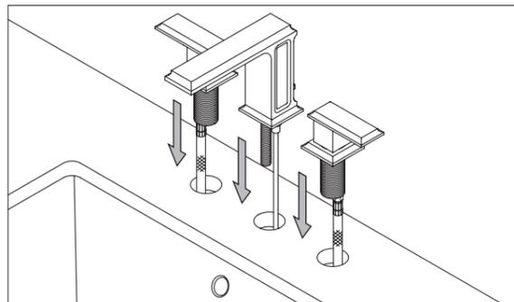
③ 左側に給湯(赤)、右側に給水(青)、中央に吐水口をカウンターの穴に差し込みます。
