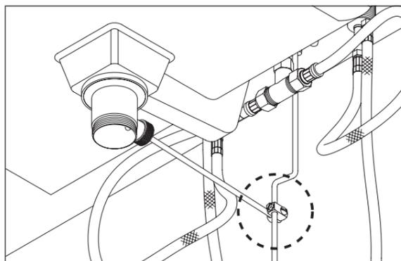
ポップアップ縦棒とポップアップ横棒をユニバーサルジョイントで接続します。ユニバーサルジョイントの接続は、図Aのように、ポップアップ横棒を太い穴に、ポップアップ縦棒を細い穴に差し込み、排水栓を閉めた状態でネジを締め、固定してください。作業が終わったら、動作を確認してください。
