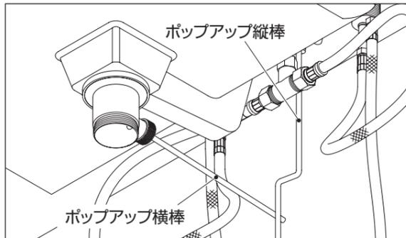
④ ポップアップ横棒取付穴がポップアップ縦棒の方を向くように、受け金具の向きを調整し、ポップアップ横棒を取り付けてください。
