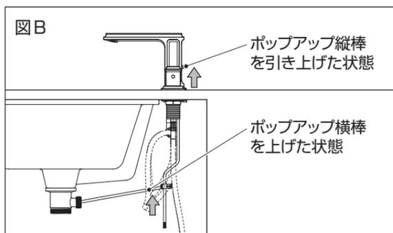
図Bの状態ユニバーサルジョイントの縦棒固定ネジ(図A参照)をドライバーでしっかり締めて、縦棒に固定してください。
