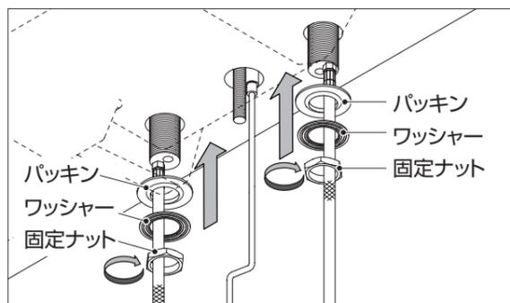
④ ハンドル取付金具を下からパッキン、ワッシャー、固定ナットの順に給湯、給水ホースに通し、固定ナットでしっかり締めます。※パッキンは、カウンター裏面に完全に接するまで手で上げてください。
