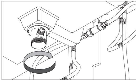
③ 受け金具は手でしっかり締め付けた後、ウォーターポンプ等で増し締めしてください。
